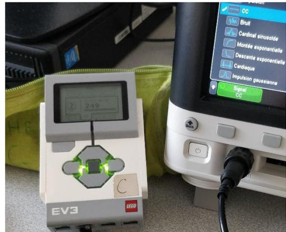
Le test est donc très convenable : Nous obtenons une tension moyenne de 2.45 V (125) quand un signal carré de 50% est envoyé. Sinon dans le cas d'un signal continu, nous recevons une tension moyenne de 4.9 V (249).
