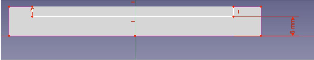
Maintenant nous voulons créer notre trou permettant la connectique, pour cela il m'a fallu mesurer la taille du composant qui ira à cet emplacement, de ce fait nous avons pris une taille de 17mm en longueur et 15mm en largeur, avec le Kicad fabriqué par Osman et que j'ai importé vers Freecad, j'ai pu voir en mettant le capteur dans ma création freecad l'emplacement du trou :
