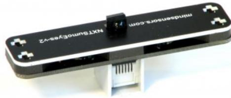
Le SumoEyes est un capteur d'obstacle adapté pour le Lego Mindstorms. Il peut détecter un obstacle devant, à droite et à gauche de lui dans un rayon d'environ 20 cm. De plus, il utilise une technologie analogique de base pour communiquer avec la brique Lego. On souhaite implanter la communication I2C, compréhensible pour la brique Lego, afin d'avoir une communication plus innovante et plus efficace. Dans ce cas, il faut commencer par effectuer une analyse du cahier des charges.
